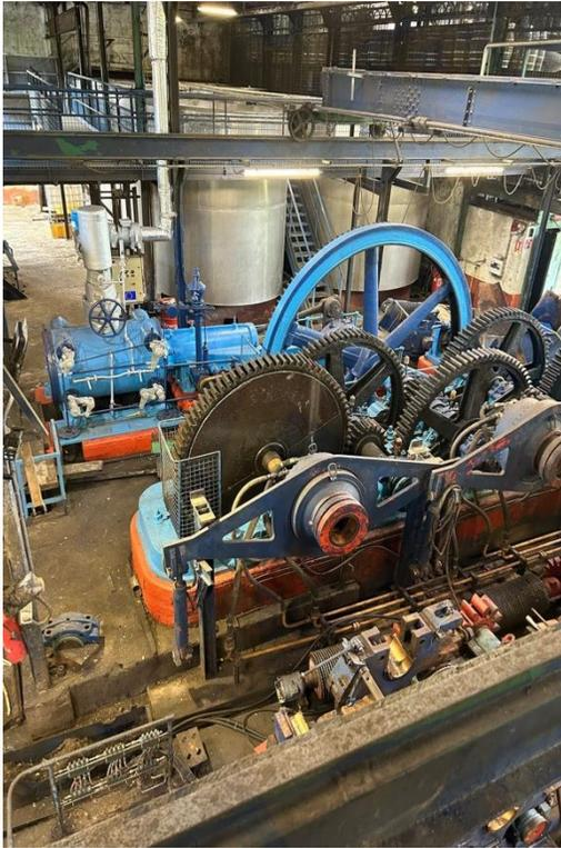
Les cannes coupées à la main sont mises dans le broyeur mis en mouvement par la machine à vapeur. Le broyage permet l'extraction du jus de canne, le **vesou**, qui sera mis en fermentation
