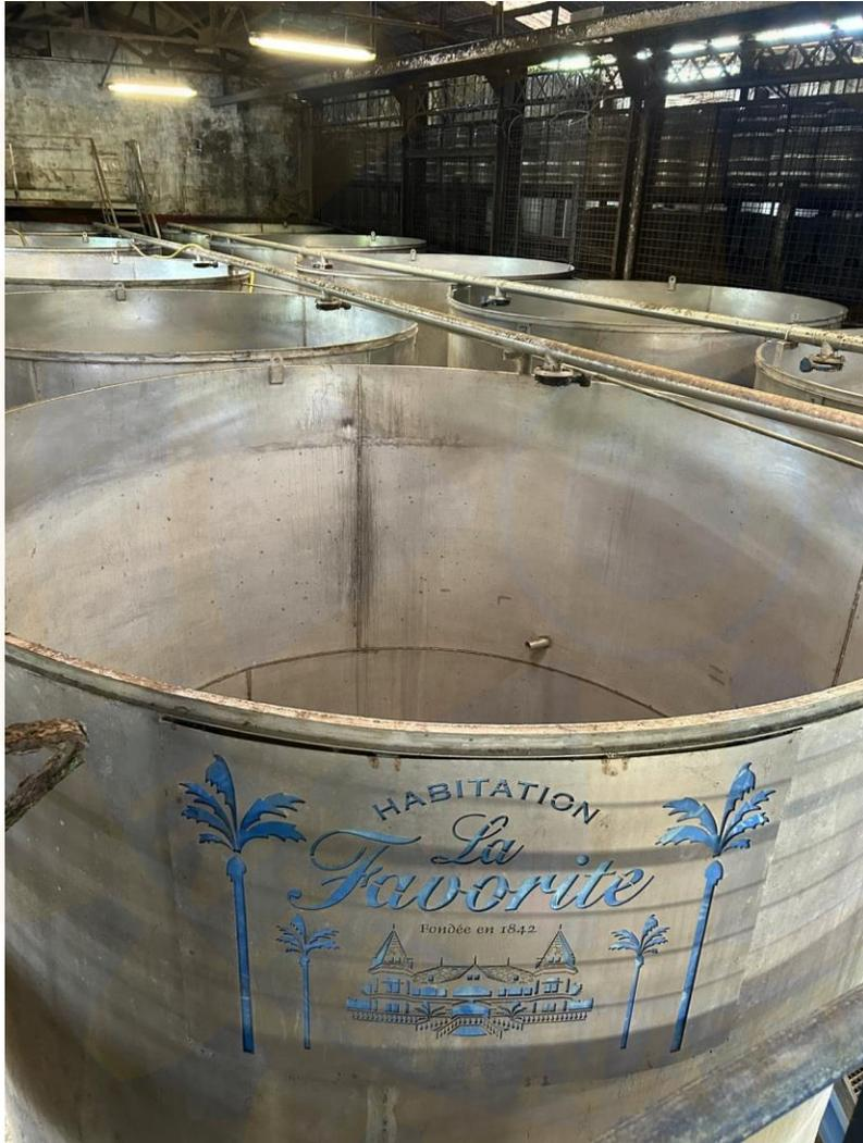
Le vesou est mis en fermentation et brassé dans les cuves inox et se transforme en vin de canne à 5% d'alcool en 48 à 72h, prêt à être distillé.
